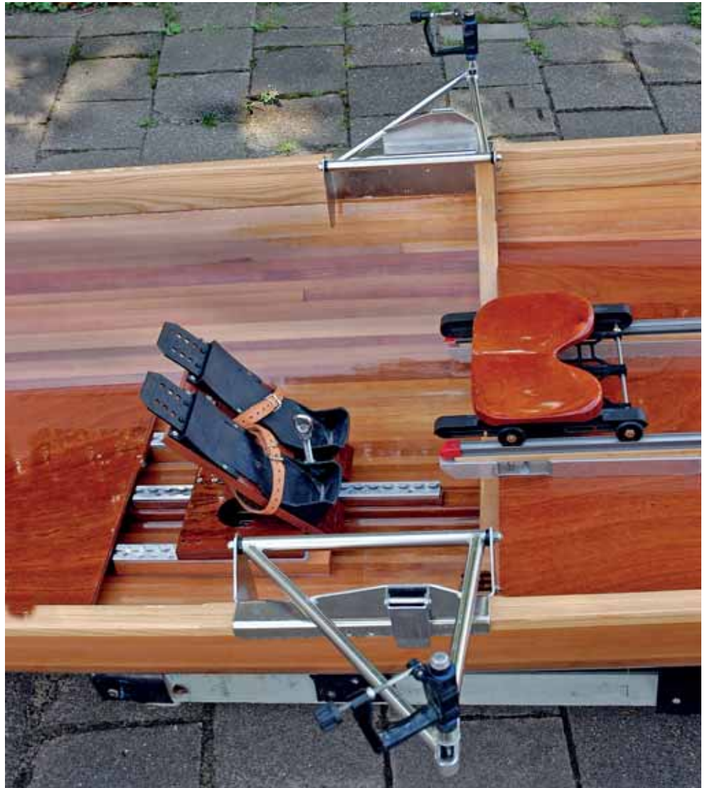
De double action roeibankjes, waarbij de slidings in Wintech hard coated aluminium zijn uitgevoerd. Standaard zijn de rvs opklapbare riggers met 'Martinoli' dollen.
